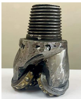
Рис. 3. Общий вид усовершенствованного трехшарошечного долота
