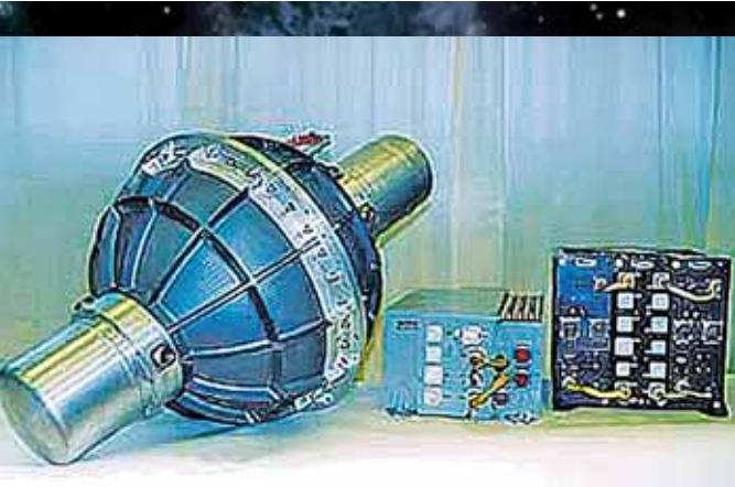
Двухступенный гиросиловой стабилизатор – гиродин
