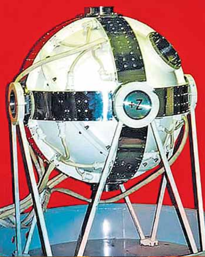
Шаровый двигатель-маховик на магнитном подвесе
