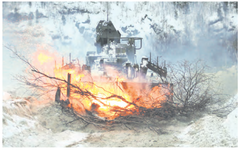
Продельвание проходов с помощью инженерной машины разграждения.
