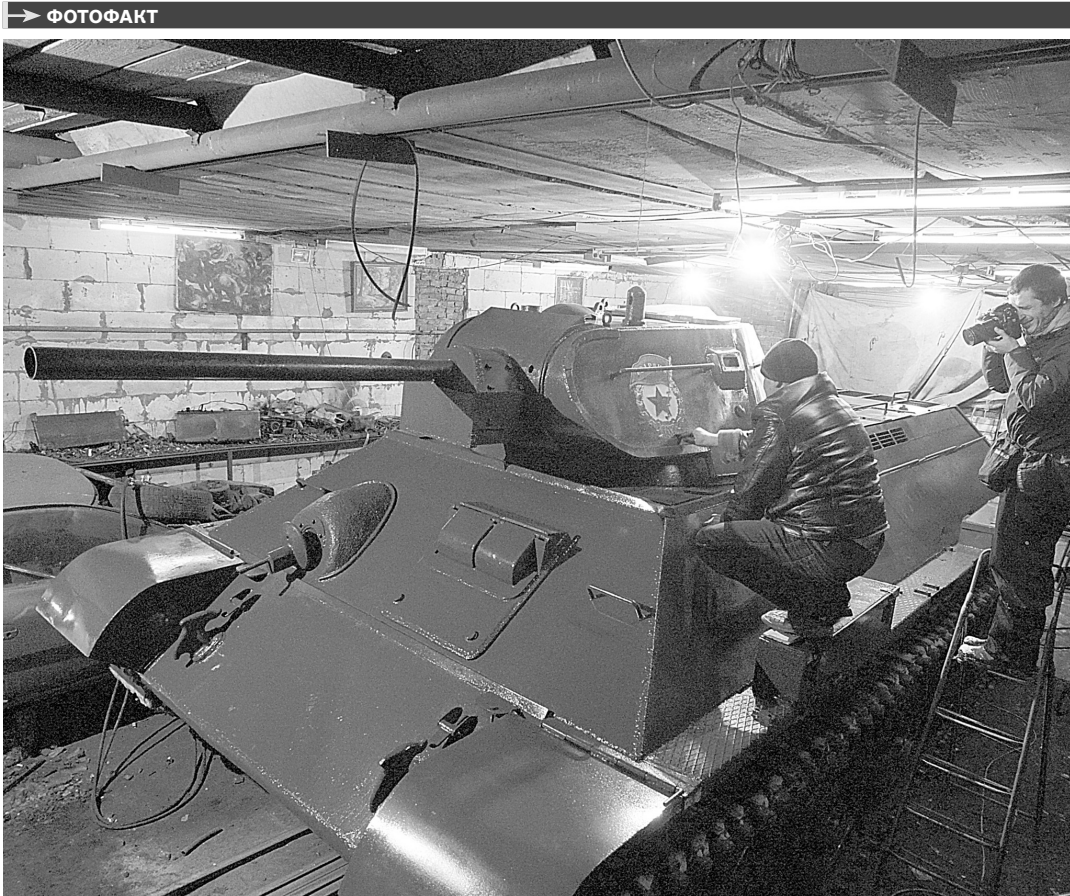
В поселке Большой Оеш Новосибирской области заканчивается изготовление копии легендарного танка «Т-34» для мемориальной композиции в Ханты-Мансийске. По словам конструктора Максима Свеклы, в машине использована ходовая часть настоящей «тридцатьчетверки». При этом танк на ходу, что является фирменной чертой мастерской Вячеслава Веревокина, дело которого продолжает Максим.
