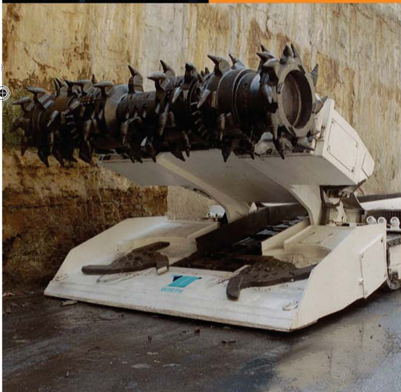
Выемочный комбайн H4.30 для работы на тонких пластах высотой мин. 1,2 м
