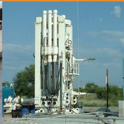
Установка HG 380-SP для бурения восстающих диаметром до 6м
