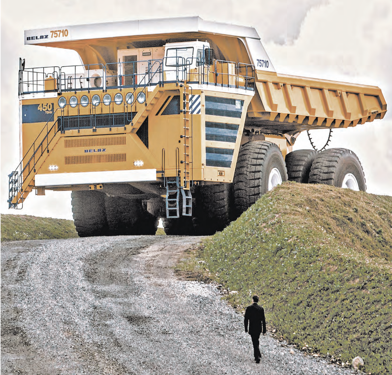
450-тонный «БелАЗ», чья высота достигает 8 метров 16 см, а диаметр колеса — больше 4 метров, получил сибирскую прописку.
