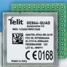
**GE864-QUAD Automotive V2** - первый GSM/GPRS модуль с интегрированной поддержкой стандарта eCall.
