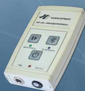
Регистратор ИР-2М с возможностью измерения поляризационного потенциала
