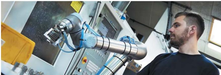
Компания Universal Robots выпустила две новые модели роботов — UR5 и UR10, встроив двигатели Kollmorgen непосредственно в оси сочленения.
