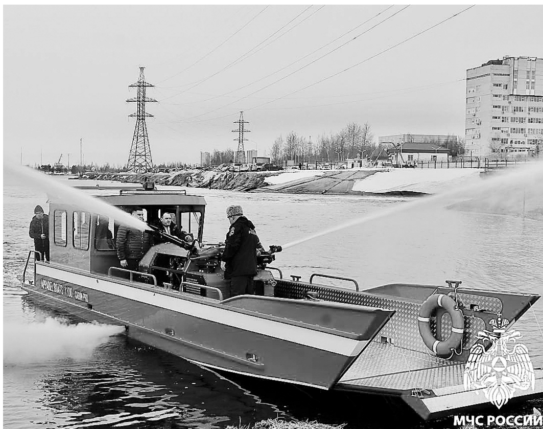
Пожарно-спасательный катер создан российскими конструкторами для тушения пожаров на акваториях и в прибрежной зоне
