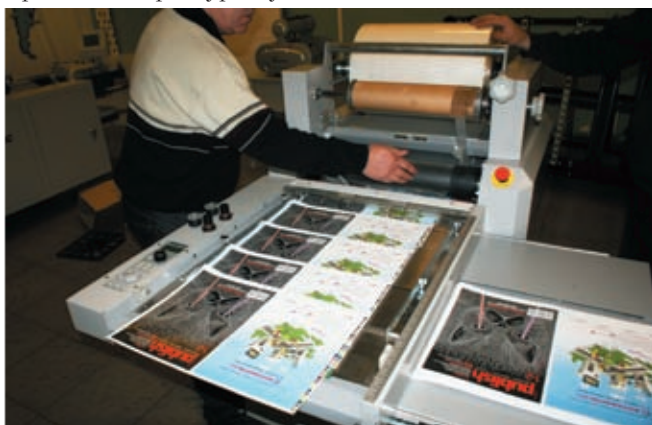
Приладка ламинирования: рука оператора указывает на эмбоссирующий вал
