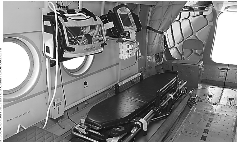
Вертолет Ми-8 обеспечен всем необходимым для реанимационных мероприятий в воздухе: аппаратом ИВЛ, многофункциональным монитором, дефибриллятором.
