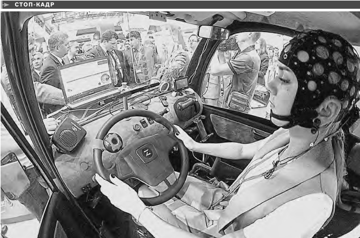
Первый в мире автомобиль, управляемый мозгом человека, представлен на международной выставке «Иннопром» в Екатеринбурге. Машина реагирует на мысленные команды водителя. В нейромобиле привычную систему управления (педали, рычаги переключения скоростей) заменяет умная начинка, реагирующая на биологические импульсы, которые передаются с помощью особого головного убора автомобилиста. На выставку привезли пилотный образец, разработанный молодыми учеными университета Лобачевского в Нижнем Новгороде. Серийный выпуск нейромобиля планируется начать через три года.
