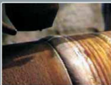
наплавка штока насоса ТЭЦ
