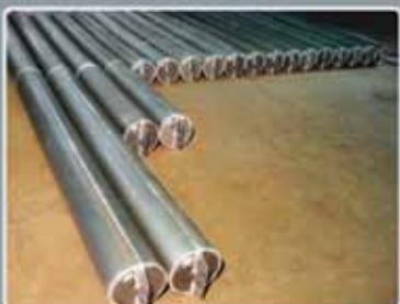
плазменная наплавка изделия из высоколегированной стали, масса изделия 2200 кг, длина 8000 мм.
