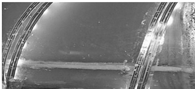
Рис. 1. Единичная секция фотобиореактора для культивирования микроводорослей
