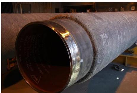
Рис. 2. Обетонированная труба для капитального ремонта подводного перехода газопровода через Байдарацкую губу
