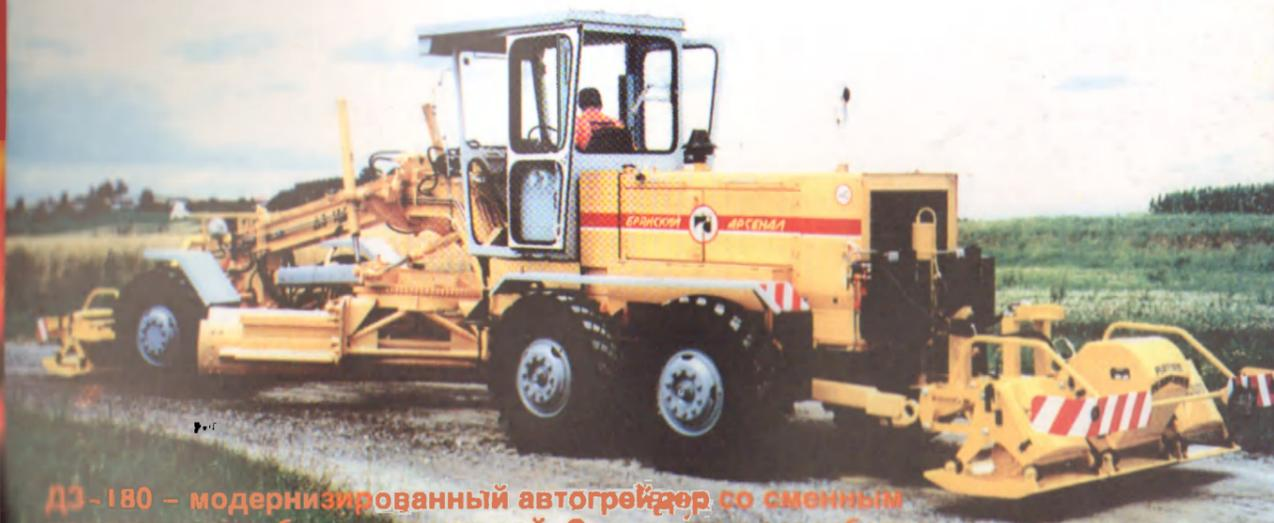
ДЗ-180 – модернизированный автогрейдер со сменным комплектом виброуплотнителей. Совместная разработка ЗАО «РЕГИТОН», АО «Брянский Арсенал» и фирмы «BOSCHUNG» (Швейцария)
