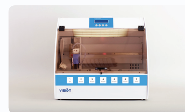
V-Chromer Устройство для автоматической окраски мазков крови
