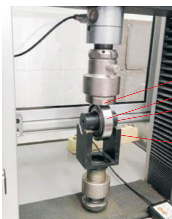
Рис. 2. Постановка эксперимента по определению нагрузочной характеристики роликового подшипника [16]: 1 — нагружающая плита; 2 — радиальный роликовый подшипник качения; 3 — штанга; 4 — стальная вилка
