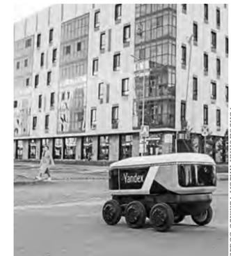
Робот-курьер передвигается по Иннополису со скоростью пешехода и маршрут следования к заказчику планирует сам.
