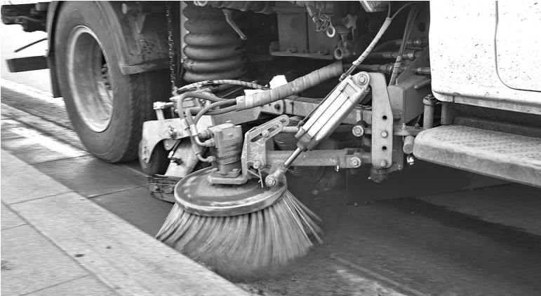
Новая техника не только сметает пыль с дороги, но и засасывает ее в бункер.
